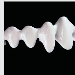
При условии правильного обжига бонд дает однородную, полуглянцевую поверхность.
